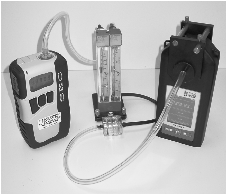
Abb. 12: Kalibrierset für das TM data II. Von links nach rechts: Pumpe, Rotameter mit GSP (davor), TM data II mit Halteklammer.
