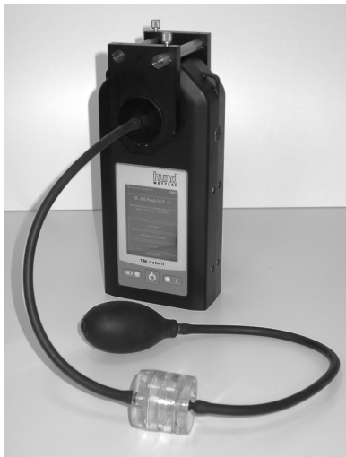
Abb. 10: TM data II mit angesetzter Nullpunkt-Einstellvorrichtung.
