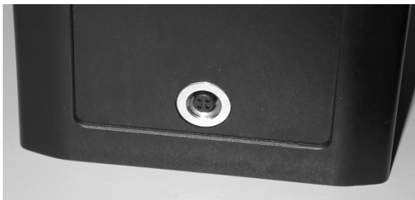
Abb. 2: Anschlussbuchse USB/Versorgung des TM data II.
