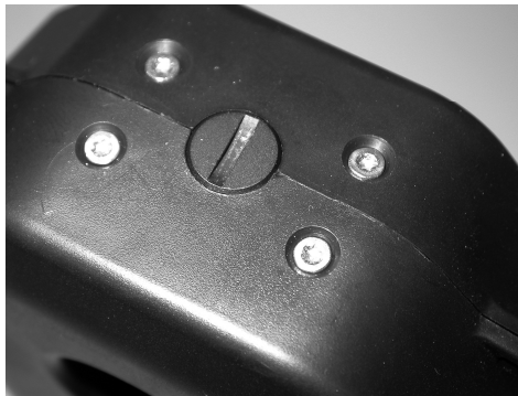
Abb. 11: Schalter für elektronischen Abgleich in Stellung „Messung“.
