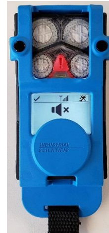
Ventis Pro mit Standby Clip (Totmann und Gasmesswerte auf Standby)
