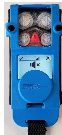
Ventis Pro con Standby Clip (funzione uomo morto e letture dei gas in standby)
