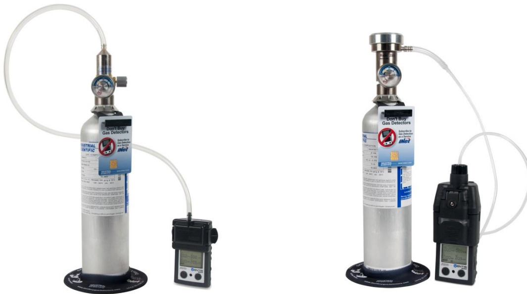
Gerät ohne Pumpe mit einstellbarem Durchflussregler
