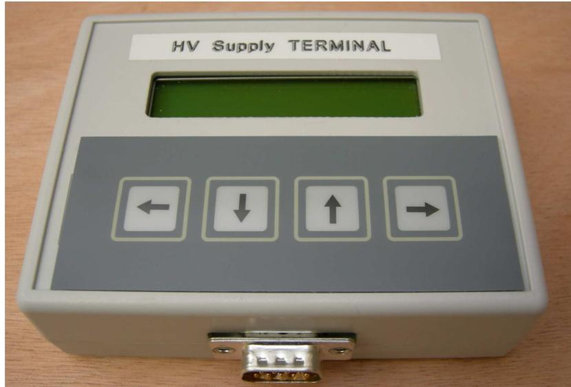
Pour se déplacer dans les différents menus du **boîtier d'alimentation hv**, l'utilisateur doit utiliser les flèches de déplacement du clavier :
