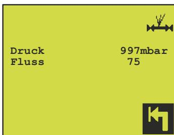
Warten, bis der Sensordurchfluss stabil ist und ein Druck von ca. 1000 mbar gemessen wird. Der Test wird im Laufe von ca. 15 Sek. durchgeführt.
