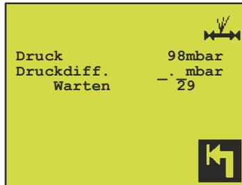
Diese Pause ist erforderlich, um die Druck- und Temperaturbedingungen zu stabilisieren, bevor die Messung der Druckdifferenz startet.
