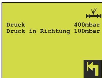
Die obere Zeile zeigt den aktuellen Druck im O<sub>2</sub> Sensor an. Unter normalen Umständen fällt dieser Druck in Richtung 100 mbar innerhalb von 10 - 20 Sek.
