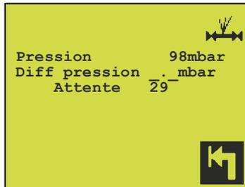
Cette pause est nécessaire pour la stabilisation des conditions de pression et de température avant le démarrage des mesures de différence de pression.
