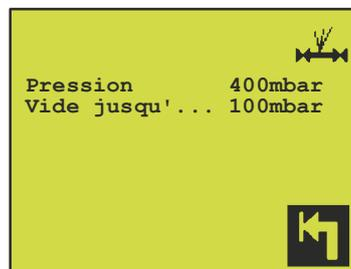
s'affiche. La ligne supérieure indique la pression dans le capteur de O<sub>2</sub>. Dans des conditions normales, cette pression descend à 100 mbar en 10 - 20 secondes.
