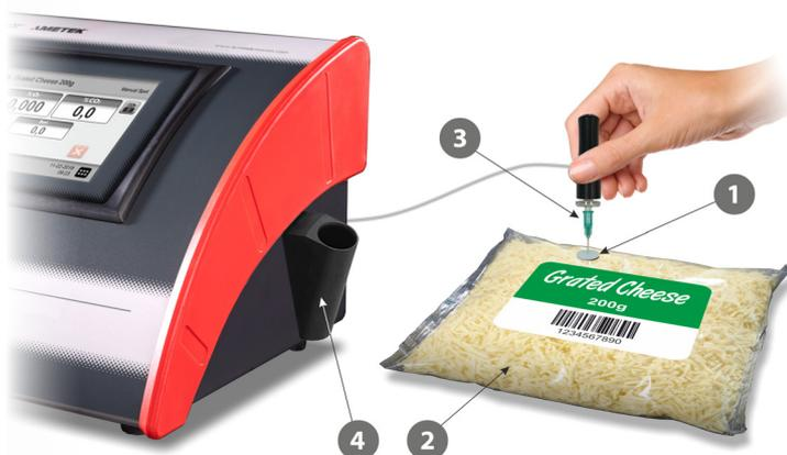
2. Placez un septum ① sur le produit/emballage ② à mesurer/analyser. Cela assurera une extraction du gaz sans fuite et garantira la précision de la mesure exécutée.
