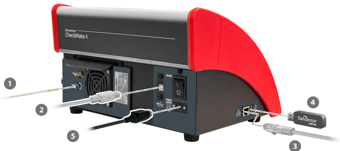
1. Raccordez le flexible ❶ du kit d'échantillonnage au connecteur « GAS IN ». Assurez-vous que le connecteur du flexible est poussé dans le raccord jusqu'à la butée. Pour vérifier la fiabilité de la connexion, tirez légèrement le flexible vers l'arrière.
