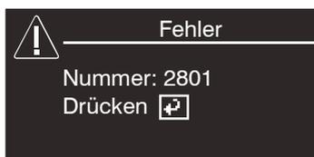
Ein Fehler wird mit Hilfe einer Zahl identifiziert (z. B. 2801).
