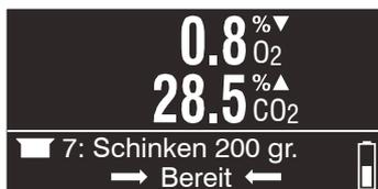
5. Bei Anzeige von "Bereit" in der unteren Zeile ist das Gerät messbereit.
