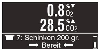
Wenn das Gerät mit einem Strichcode-Lesegerät ausgestattet ist, einfach den entsprechenden Produktstrichcode durch Drücken der Taste ablesen. Ansonsten oder betätigen, um zur Liste der verfügbaren Produkte zu springen.
