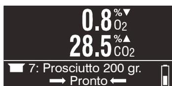
5. Se il display mostra "Pronto" (in fondo allo schermo), il dispositivo è pronto per iniziare la misurazione.
