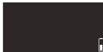
Il display è nero, ma se il dispositivo è collegato all'alimentazione per mezzo del cavo caricabatterie/USB oppure tramite la stazione DockIn, il dispositivo sarà sotto carica ed il display mostrerà quindi l'indicatore di batteria.
