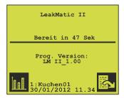
Ist die Online-Messung aktiviert ( ), beginnt diese automatisch, sobald die Anzeige "Bereit in xx Sek" Null erreicht hat. Wurde die Online-Messung nicht gestartet ( ), schält das System in den Standby-Modus".
