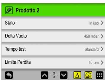
11. Toccare l'icona gialla per aprire la funzione di misurazione del test...
