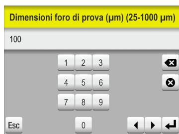
... digitare **100** come dimensione corrente del foro di prova e premere il tasto **⬅**.
