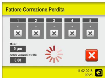
9. Al termine del test, il risultato viene visualizzato nel campo corrispondente, viene quindi calcolato un valore **Medio** e il valore nel campo **Fattore Correzione Perdita** viene aggiornato di conseguenza.
