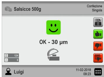
I risultati delle misurazioni effettuate nella modalità **Confezione Singola** vengono letti come la dimensione del foro calcolata in **µm**, mentre i risultati delle misurazioni effettuate nella modalità **Confezioni Multiplo** vengono interpretati come l'aumento misurato del livello di CO<sub>2</sub> nella camera espresso in **ppm/s**.
