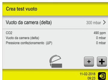
5. Impostare il **Vuoto da camera (delta)** su **300 mbar** e chiudere la camera per avviare la misurazione.
