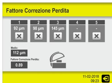
... è possibile eliminarla premendo il pulsante sotto al risultato della misurazione. Se si desidera lasciare la funzione, è possibile toccare l'icona nell'angolo in basso a destra ...
