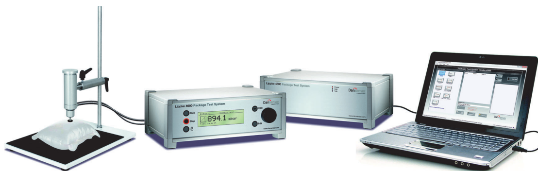
Fig. 1. Systèmes de test d'emballage Lippke 4000/4500
