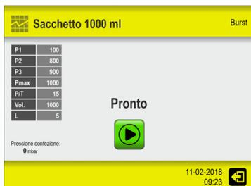
Questa schermata di test funziona esattamente come quella normale, in cui i test vengono eseguiti su una confezione con i valori impostati. La differenza è che nessuna misurazione eseguita su questa schermata verrà memorizzata nel log dei dati.
