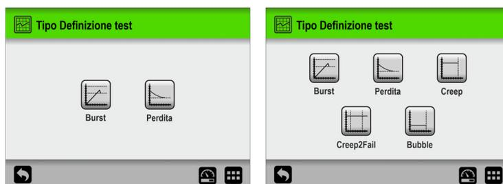
2. Selezionare il tipo appropriato di test, ad es. **Burst**.
