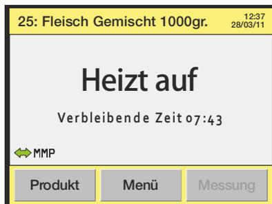
Während dieser Phase ist die Schaltfläche “Messung” deaktiviert. Ist das Gerät auf “Autostart” eingestellt, startet es nach Abschluss der Heizphase automatisch. Während der Heizphase können Sie auf das **Hauptmenü** zugreifen, indem Sie auf die Schaltfläche **Menü** tippen (siehe *“Hauptmenü” auf Seite 55*).
