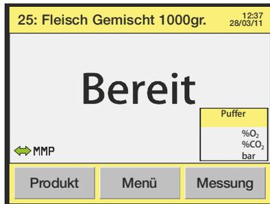
Ist das Gerät für die Durchführung von Puffermessungen eingerichtet, wird der "Puffer"-Bildschirm in der rechten unteren Bildschirmecke angezeigt.
