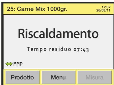
Durante tale intervallo di tempo, il tasto "Misurazione" rimane disattivato. Se il dispositivo è impostato su "Avvio automatico", si avvierà automaticamente quando la fase di riscaldamento è terminata.
