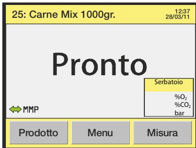
Se il dispositivo è impostato per realizzare misurazioni del serbatoio, la finestra "Serbatoio" viene visualizzata nell'angolo in basso a destra del display.
