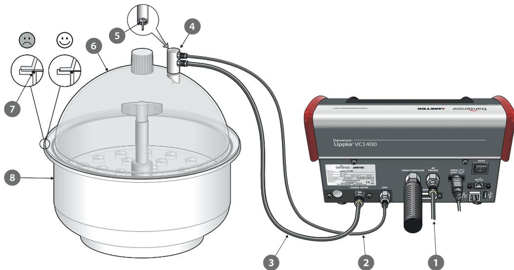
1. Vergewissern Sie sich, dass der Vakuu-/Luftdruckschlauch **1** ordnungsgemäß zwischen dem Gerät und der Luftdruck- oder Vakuumpumpe angeschlossen ist und dass der Messschlauch **2** und der Vakuumpummschlauch **3** ordnungsgemäß zwischen dem Gerät und den entsprechenden Anschlüssen am Exsikkatoradapter **4** angeschlossen sind.
