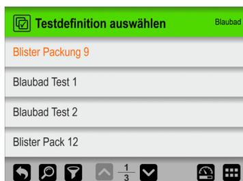
3. Im Bildschirm
