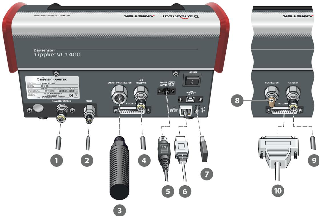
1. Collegare il tubo per vuoto da  $\varnothing$  6/4 mm **1** dall'essiccatore al connettore "CHAMBER VACUUM".
