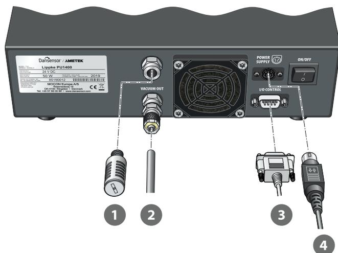
1. Collegare il filtro antirumore ① al connettore di uscita "EXHAUST".
