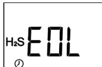
Se l'unità visualizza "EOL", la durata residua dell'unità sarà inferiore a 8 ore.
