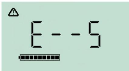
S'il n'y a pas de différence significative entre les niveaux des gaz neutre et étalon, l'étalonnage ne sera pas valide et le message **E - - 5** s'affiche à l'écran. Dans ce cas, les niveaux d'étalonnage valides précédents seront utilisés.
