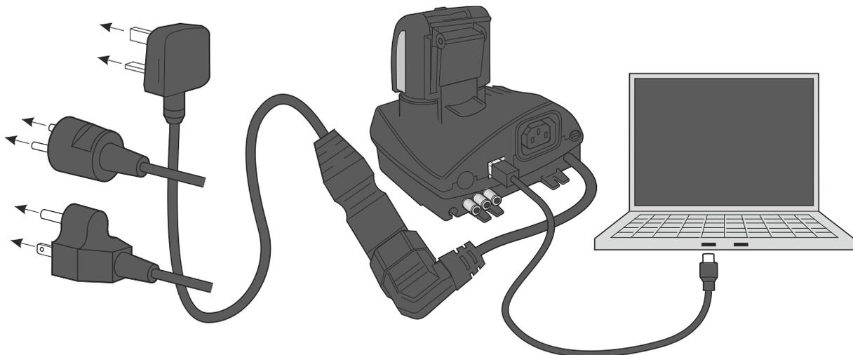
La Cub Doc doit être allumée (le témoin de charge doit être vert) pour qu'une connexion USB puisse être établie.
