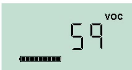
L'écran change et affiche une mesure en direct du capteur. *Ce nombre ne se rapporte pas à la concentration de gaz, il indique simplement le changement de la sortie du capteur.*
