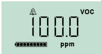
Si le niveau de gaz détecté déclenche une alarme de niveau élevé, l'écran d'affichage et les témoins lumineux situés sur le dessus de l'appareil clignotent en rouge.
