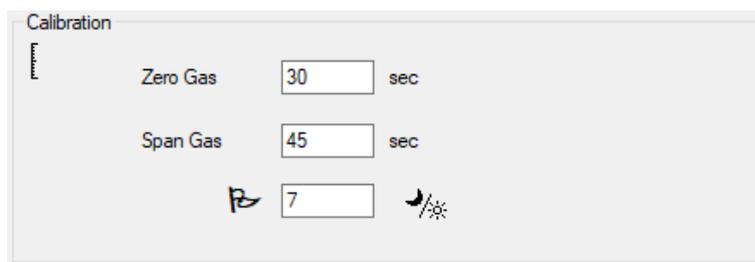
Dans les champs **Gaz neutre (Zero Gas)** et le **Gaz étalon (Span Gas)**, saisissez le nombre de secondes pendant lesquelles le gaz neutre et le gaz étalon doivent être envoyés au Cub connecté pour son étalonnage.
