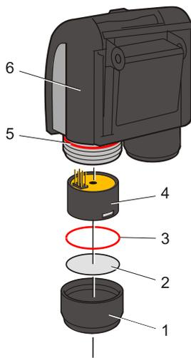
Avant de nettoyer ou de remplacer la lampe, vous devez retirer le capteur MiniPID.
