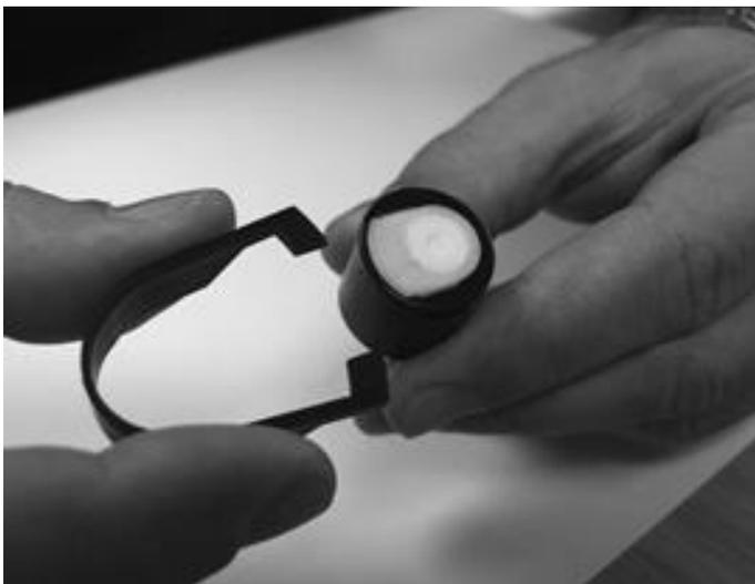
Usando lo strumento di rimozione dell'electrode stack Mini PID in dotazione, individuare i "poli" negli alloggiamenti sul lato del corpo del sensore Mini PID 2.
