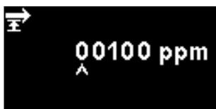
La limite inférieure de la plage de sortie 4 – 20 mA, mappée sur 4 mA, est de 0 ppm. Cette option est utilisée pour définir la limite supérieure, mappée à 20 mA.
