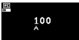
Permet de sélectionner une adresse esclave Modbus.
