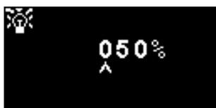
Utilisée pour régler la luminosité du voyant d'état pendant le fonctionnement normal, de 0 à 100 %, ou en mode AUTO.
