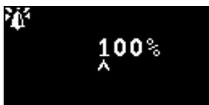
Usato per impostare la luminosità della spia di stato durante le condizioni di allarme, da 0 a 100%, o in modalità AUTO.
