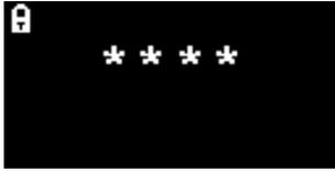
Usato per attivare e disattivare il blocco della password e per modificare il numero della password.
