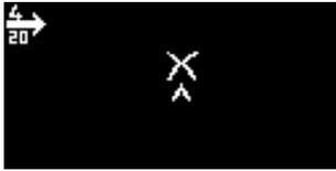
Usate per attivare e disattivare l'uscita da 4mA a 20mA.
