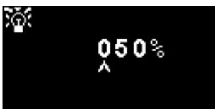
Usata per impostare la luminosità della spia di stato durante il normale funzionamento, da 0 a 100%, o in modalità AUTO.
