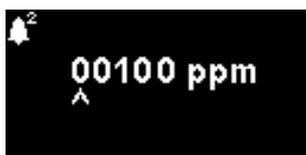
Allarme 2 Usato per impostare il livello di ppm al quale scatta l'Allarme 2 (rosso). Quando si accede, lo schermo visualizza il livello corrente.
