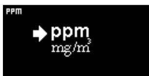
Usato per modificare le unità di rilevamento dal valore predefinito di ppm ai milligrammi per metro cubo ( $\text{mg}/\text{m}^3$ ).
