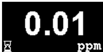
La schermata appare quindi in modalità continua e mostra la lettura PID e le unità. Il colore della spia di stato dipende dallo stato.
