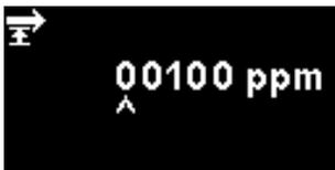
Il limite inferiore del campo di uscita da 4 -mA a 20 mA, mappato su 4 mA, è 0 ppm. Questa opzione è usata per impostare il limite superiore, mappato su 20 mA.
