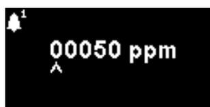
Usato per impostare il livello di ppm al quale si attiva l'Allarme 1 (giallo). Quando si accede, lo schermo visualizza il livello corrente.
