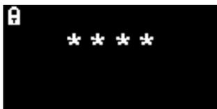
La schermata di blocco viene visualizzata se è stata inserita una password numerica (cfr. menu **i6**). Questa password protegge lo strumento da regolazioni non autorizzate - i menu (cfr. qui di seguito), non possono essere accessibili fino a quando non sarà stato inserito il numero corretto.
