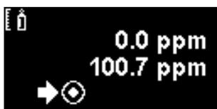
Il valore superiore è la lettura in ppm in tempo reale del dispositivo Falco (basata sulla calibrazione precedente)
