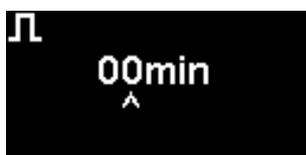
Il ciclo di misurazione può essere impostato da continuo a 10 minuti con incrementi di 1 minuto
