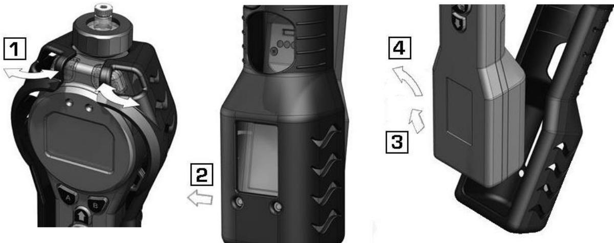
3. Relâchez le clip à l'arrière de l'instrument et retirez le bloc-piles rechargeable du boîtier de l'instrument tout en le faisant légèrement glisser vers l'arrière :
