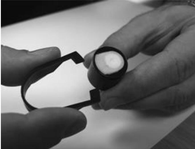
À l'aide de l'outil de retrait de pile d'électrodes Mini PID fourni, localisez ses « dents » dans les fentes sur le côté du boîtier du capteur Mini PID 2: En utilisant l'index pour retenir la pile d'électrodes blanches (les parties internes du capteur MiniPID 2 sont à ressort), appuyez sur l'outil de retrait pour libérer la pile d'électrodes.
