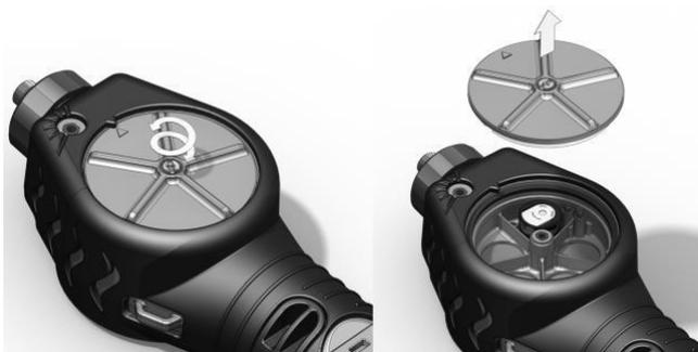
Sur le couvercle du capteur, desserrez la vis centrale en la tournant avec une petite pièce de monnaie ou à l'aide d'un tournevis à lame plate approprié, facilitant ainsi son retrait.
