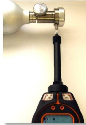
8. Falls Sie einen Fließregulator verwenden, schalten Sie das Gas ein und drücken Sie die Taste „ENTER“, um die Kalibrierungsroutine zu starten. WICHTIG: Schalten Sie das Kalibrierungsgas am Ende des Testzyklus aus.
