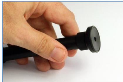
Die Filterscheibe muss ausgetauscht werden, wenn sie sichtbar verschmutzt ist oder nicht mehr richtig sitzt. Die Filterscheibe kann vorwärts oder rückwärts eingebaut werden; nachdem sie einmal verwendet wurde, darf die Ausrichtung jedoch nicht mehr verändert werden.
