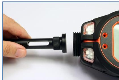
3. Bringen Sie den O-Ring auf der Filterklemme an und drücken Sie die Baugruppe so in das Filtergehäuse, dass das Fenster nach vorn zeigt. Eventuell muss beim Befestigen der Filterabdeckung ein kontinuierlicher Druck ausgeübt werden, um die Baugruppe in Position zu halten.
