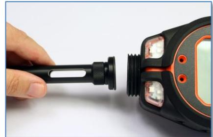
3. Placez le joint torique sur la lampe à filtre et introduisez l'ensemble dans le boîtier du filtre, la lucarne tournée vers l'avant. Exercez une pression continue pour que l'ensemble se mette en place tout en serrant le capuchon de filtre.
