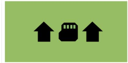
Wenn Sie die Speicherkarte entfernen, ändern die Pfeile ihre Richtung. Dies zeigt an, dass Sie eine Karte einführen müssen. Verwenden Sie den Magneten, um Schalter 1 für 5 Sekunden zu betätigen und somit das Menü zu verlassen.
