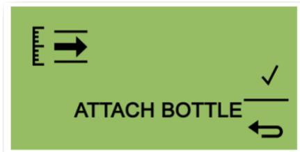
Schließen Sie die Flasche an, bevor Sie mit der Kalibrierung beginnen. Dies stellt sicher, dass das Benzol vor dem Beginn der Kalibrierung durch das Titan-System fließt.
