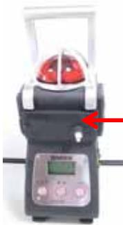
Messkappe mit Anschluss für die Ansaugvorrichtung (elektrische oder manuelle Pumpe)
