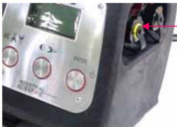
Zwei Relaisausgänge (Gasalarm und Störung) und zwei Logikeingänge (Fernquittierung und Alarmübertragung)
