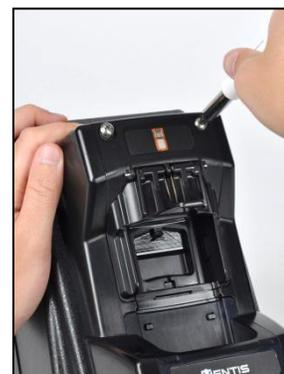
Serrer les vis captives supérieures\* en appuyant pour comprimer le ressort tout en les tournant dans le sens horaire.
