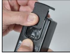
5. Retirez le couvercle de l'autre extrémité du câble d'alimentation : appuyez sur la languette et faites glisser le couvercle dans la direction indiquée. Rangez le couvercle en cas d'utilisations futures.
