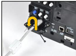
15. Au-dessous du support de fixation, insérez l'extrémité étroite du serre-câble à travers le trou à droite du câble que vous attachez. Glissez le serre-câble par-dessus le câble, puis poussez-le vers le bas à travers le trou à gauche du câble. Guidez l'extrémité à travers la tête du serre-câble
