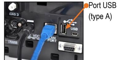
Une fois connecté, les fichiers suivants sont téléchargés automatiquement sur le périphérique quand un appareil est relié : les journaux de données de l'appareil et les enregistrements de tests de déclenchement et d'étalonnages réalisés sur la station d'accueil.
