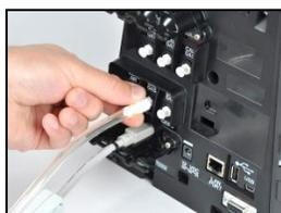
18. Reliez le connecteur pivotant blanc du tube au port CAL GAS situé directement au-dessus du port câble iGAS 2. Faites-le tourner dans le sens des aiguilles d'une montre pour le resserrer.
