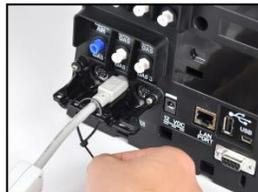
16. Tirez sur le serre-câble pour bloquer le câble en place.
