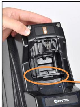
Positionner l'onglet inférieur de l'insert de recharge dans la découpe de l'ouverture et le mettre fermement en place.
