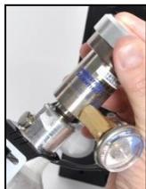
10. Connectez le bon régulateur de débit à la bouteille. Tournez la bouteille dans le sens des aiguilles d'une montre pour resserrer.
