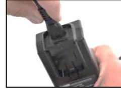
6. De la même façon, remplacez le couvercle par l'adaptateur qui convient à votre prise (ci-dessus à gauche). Si un câble d'alimentation dédié a été commandé, utilisez-le à la place de l'adaptateur (ci-dessus à droite).
