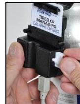
13. Si le régulateur est équipé d'un pressostat (recommandé pour les unités DSXi et obligatoire pour les comptes iNet), branchez l'attache dans l'encoche située sur le côté du lecteur de carte.
