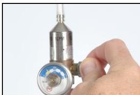
Um den Fluss des Gases zu stoppen, drehen Sie den Hahn des Regulators im Uhrzeigersinn und ziehen Sie ihn fest.
