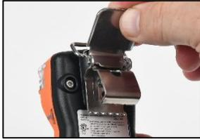
Heben Sie die Abdeckung des Clips an.
