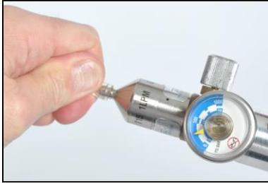
Verbinden Sie ein Ende der Kalibrierhülse mit dem Anschluss am Regulator.
