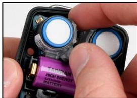
Greifen Sie die Sensorhalterung vorsichtig mit Daumen und Zeigefinger oben und unten und nehmen Sie sie ab. Das Oberteil der Halterung ist schmaler als das Unterteil.
