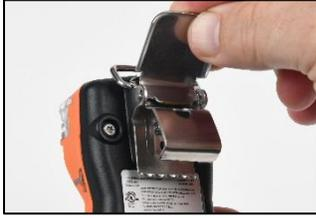
Heben Sie die Abdeckung des Clips an.
