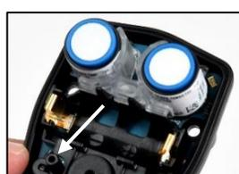
Die innere Stromtaste befindet sich unter der Halterung für die Batterieablage und links vom Lautsprecher (siehe oben). Drücken Sie diesen Knopf und halten Sie ihn zwei Sekunden lang gedrückt, bevor Sie ihn loslassen.
