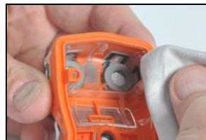
Drücken Sie mit einem sauberen, weichen Tuch entlang der Kante der Dichtung und halten Sie sie 5 Sekunden lang gedrückt, um sie festzukleben.
