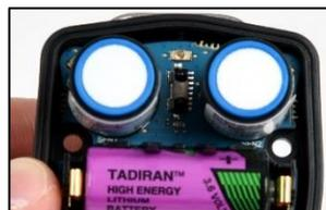
Den Sensor seitlich greifen und herausnehmen (s. rechtes Bild) - Vermeiden Sie eine Berührung der Sensoren oben. Manche Sensoren können mit Klebeband befestigt sein; wenden Sie leichten Druck an, um die Sensoren anzuheben und herauszunehmen. Legen Sie ihn zur späteren Verwendung zur Seite oder entsorgen Sie ihn gemäß den Richtlinien Ihres Unternehmens.
