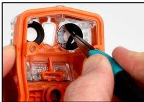
Greifen Sie die Dichtung und den darunter liegenden Sensor im Innern des Gehäuseoberteils mit einer Pinzette und ziehen Sie leicht, um ihn vom Blatt zu nehmen.
