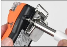
Entfernen Sie mit einem Torx-Schraubendreher alle vier Schrauben vom Gehäuseunterteil und legen Sie sie zur Seite.
