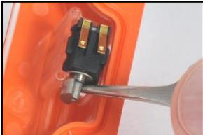
Setzen Sie die Pinzette zwischen Gehäuseoberteil und Motor. Hebeln Sie nach oben, um den Motor auszubauen.
