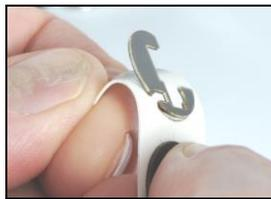
Die Platten kleben auf einer Papierunterlage. Biegen Sie das Papier zurück, um es von den Platten zu trennen. Greifen Sie die Platte vorsichtig oben mit der Pinzette; entfernen Sie sie vorsichtig ganz vom Papier. Führen Sie die Platte – mit der Klebeseite nach unten – zur richtigen Position auf der Leiterplatte (siehe oben rechts). Achten Sie darauf, dass die Plattenkante mit dem Umriss des Sensors auf der Karte übereinstimmt.
