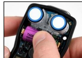
Richten Sie den Ersatz-Akku so aus, dass die Plus- und Minusanschlüsse mit den „+“ bzw. „-“ Markierungen an der Halterung übereinstimmen. Setzen Sie den neuen Akku mit dem Minusanschluss zuerst in die Halterung ein. Drücken Sie den Akku nach unten, um ihn in der Halterung zu sichern.
