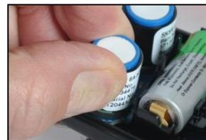
Sichern Sie den Sensor, indem Sie vorsichtig auf die Seiten des Sensorgehäuses drücken. Achten Sie darauf, die weiße Membran des Sensors nicht zu berühren. Wenn der Sensor sicher in seiner Position sitzt, ist eine leichte Auswirkung der Verbindung zu spüren. Setzen Sie den Sensor wieder ein, mit den Füßen nach unten, Kerben nach vorne Richtung Batterie.
