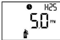
Bump-Test wird ausgeführt
