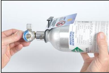
Halten Sie den Regulator und drehen Sie den Kalibriergas-Zylinder zum Festziehen im Uhrzeigersinn.
