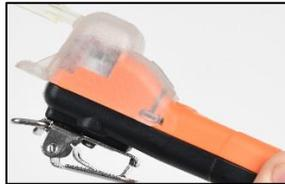
Positionieren Sie den Kalibrierbecher über dem Gehäuseoberteil. Richten Sie die obere Kerbe des Bechers mit der kleinen Erhöhung an der Oberseite des Geräts aus. Drücken Sie nach unten, um den Clip in seiner Position zu sichern. Sie hören einen Klick.
