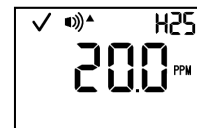
Seuil d'alarme haute
