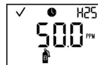
Application du gaz pour le test de déclenchement
