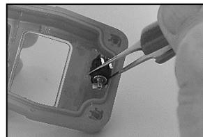
Greifen Sie den neuen Motor leicht mit der Spitzzange.
