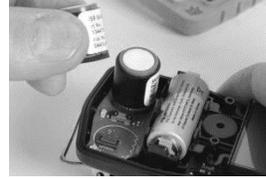
Zwischen den zwei installierten Sensoren befindet sich eine Sensorhalterung, die für zusätzliche Stabilität der Sensoren während des Betriebs sorgt. Greifen Sie vorsichtig mit Daumen und Zeigefinger die Oberseite und Unterseite der Sensorhalterung, um sie zu entfernen. Legen Sie sie beiseite.
