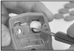
Setzen Sie den neuen Filter – mit der Klebefläche nach unten – in die Filteröffnung ein.
