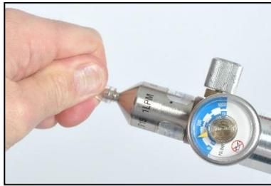
Schließen Sie ein Ende des Kalibrierschlauchs am Anschlussnippel des Reglers an.
