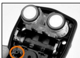
Die innere Ein-/Aus-Taste befindet sich unter der Batterie-Station links neben dem Lautsprecher. Drücken Sie diese Taste und halten Sie sie zwei Sekunden lang gedrückt. Lassen Sie sie dann wieder los.
