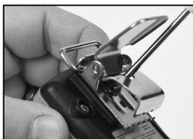
Verwenden Sie einen Torx-Schraubendreher, um die Schraube des Clips zu entfernen. Lösen und entfernen Sie die Schraube, indem Sie diese gegen den Uhrzeigersinn drehen.
