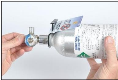
Halten Sie den Regler fest und drehen Sie den Gaszylinder im Uhrzeigersinn, um ihn festzuziehen.
