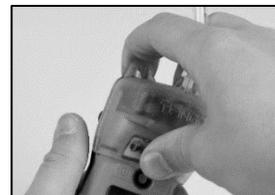
**Stoppen Sie die Gasströmung!** Drehen Sie den Drehknopf des Reglers im Uhrzeigersinn, bis er fest angezogen ist.
