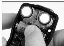
Richten Sie die neue Batterie so aus, dass die positiven und negativen Enden mit den Markierungen „+“ und „-“ der Station übereinstimmen. Legen Sie die Batterie mit dem negativen Ende zuerst in die Station.
