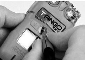
Entfernen Sie die Staubsperr mit dem Finger oder einer Spitzzange. Entsorgen Sie die gebrauchte Sperr.
