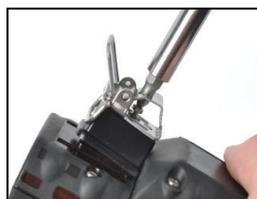
Guider la vis dans le trou de l'entretoise et dans le fond du boîtier de l'appareil.
