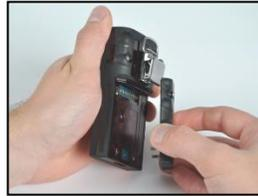
Dévisser, soulever et retirer la pile de l'appareil à diffusion ; la mettre de côté pour utilisation ultérieure.
