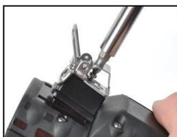
Pour déposer la pince, utiliser un tournevis Torx pour accéder à la vis de fixation de la pince. Tourner dans le sens antihoraire pour desserrer la vis.
