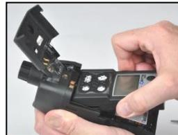
Placer l'appareil dans le boîtier de pompe ; serrer\* les quatre à empreinte étoile au dos de la pompe.
