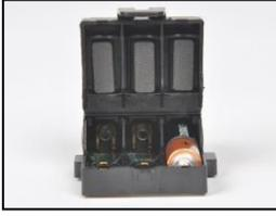
1. Déverrouiller et soulever la portion articulée du compartiment des piles.
