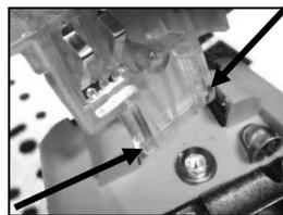
Le couvercle est articulé sur le module de pompe au moyen de deux ergots qui se glissent dans des gorges. Faire pivoter le couvercle de façon à ce que l'un des ergots soit placé à la partie inférieure de sa gorge et l'autre à la partie supérieure de la sienne. Soulever le couvercle pour le déposer. Installer le nouveau couvercle de la même façon qu'il a été déposé.
