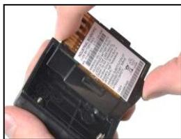
Pour installer la pile à longue durée, la placer d'abord dans le couvercle-pile. Lorsque la pile est placée correctement, son étiquette est visible.
