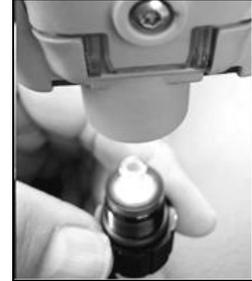
Retourner l'instrument. Placer le nouveau filtre interne dans le cylindre d'admission du module de la pompe.
