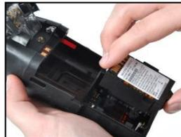
Installer une pile à longue durée compatible – avec l'étiquette sur le dessus – dans le réceptacle inférieur du boîtier de pompe.
