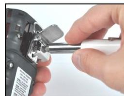
Pour fixer la pince, mettre la rondelle sur la vis et placer la vis dans le trou du milieu de la pince.
