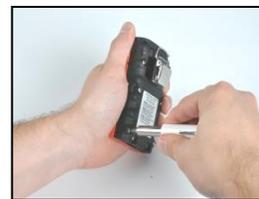
À l'aide d'un tournevis étoile, serrer\* chacune des quatre vis pour fixer la pile (illustration) ou le couvercle-pile sur l'appareil.
