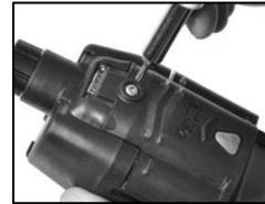
Ziehen Sie die Schraube an der Pumpentür fest.
