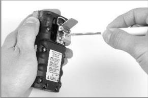
Drehen Sie die Schraube an der Gürtelklemme heraus und entfernen Sie die Klemme. Heben Sie Klemme, Schraube und Unterlegscheibe zur späteren Verwendung auf.
