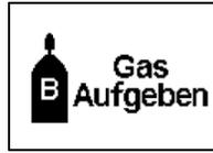
Die Sensoren sind so eingestellt, dass sie auf die angezeigten Kalibriergaskonzentrationen reagieren. Das Gerät wartet ca. fünf Minuten auf das Aufgeben der erforderlichen Gaskonzentration.
