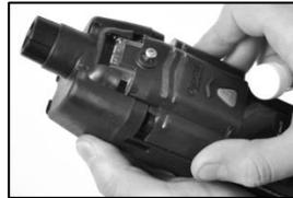
Schieben Sie die Pumpentür nach unten, bis sie ganz schließt und einrastet.
