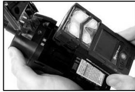
Legen Sie das Gerät wie gezeigt in das Pumpengehäuse.
