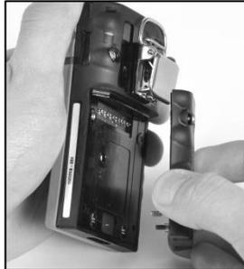
Lösen Sie den Akku und nehmen Sie ihn aus dem Diffusionsgerät; heben Sie ihn zur späteren Verwendung auf.
