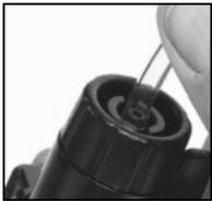
Befestigen Sie ein Ende des Probenschlauchs am Nippel des Pumpeneinlasses; befestigen Sie das andere Ende an einer kompatiblen Wassersperre.
