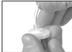
Drücken Sie an beiden Enden auf den Schlauch, um sicherzustellen, dass das Anschlussstück ganz in den Schlauch eingeführt ist (ca. 0,635 cm [0,25"]). Ziehen Sie vorsichtig am Schlauch, um auf festen Sitz zu prüfen.
