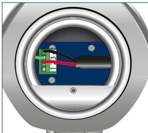
Schéma 6 Connexion du bornier
