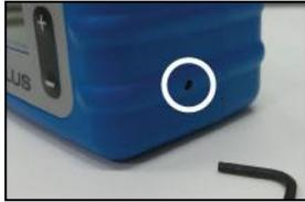
**Nota:** Il campionatore può essere impostato a basso flusso (fino a 445 cc/min) o ad alto flusso (da 450 a 5100 cc/min). La modalità può essere selezionata attraverso l'uso di una chiave torx (in dotazione), inserendola nel foro laterale (in figura). L'indicazione dell'impostazione è fornita a display; "Lo" per basso flusso e "Hi" per alto flusso.
