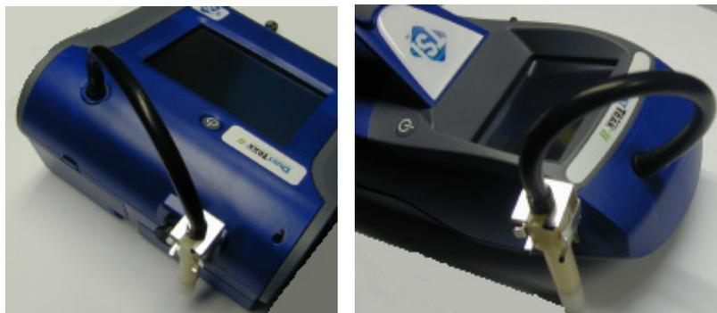
**Figure 2-5 : Installation du cyclone Dorr-Oliver**
