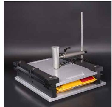
Ausdehnungsbegrenzung gemäß ASTM F2054 - hält die Packung flach, um sicherzustellen, dass der Druck auf alle Siegelnähte gleichmässig wirkt
