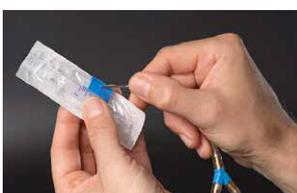
Ein Septum sorgt für einen luftdichten Verschluss und schützt die Verpackung vor dem Aufreißen. Verschiedene Septentypen eignen sich für verschiedene Verpackungen und Nadeln.
