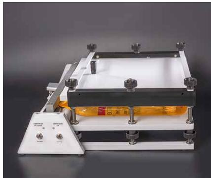
Pneumatische Packungsklemme (PPC 300 II) - Durchführung von Berstprüfungen für Verpackungen oder Beutel, die auf einer Seite offen sind
