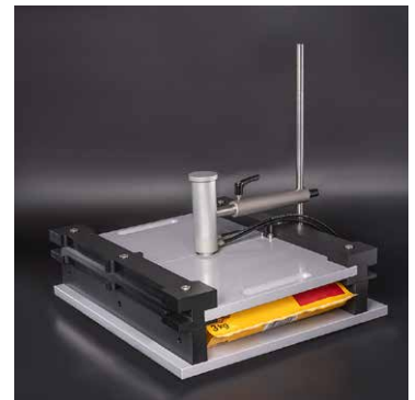
La plaque de retenue pour retenue ASTM F2054 - retient l'emballage pour assurer que la pression s'exerce de façon correcte sur les soudures de l'emballage
