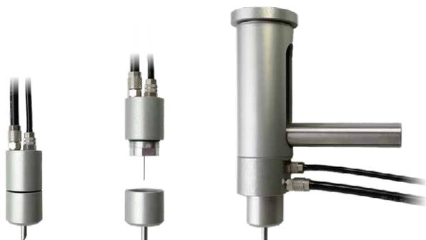
Sia l'ago manuale che la test head hanno una sonda integrata e possono essere dotate di un ago appuntito o di un ago piatto di 4mm
