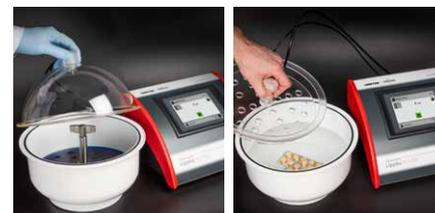
Test au colorant bleu de méthylène avec couvercle
