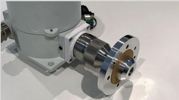
Der Flanschadapter ermöglicht die totvolumenarme und dichte Adaptionen des ungepumpten FALCO VOC Gasdetektors für Anwendungen bei denen an einem Abluftkanal o.ä. ein sicherer und komfortabler Zugang geschaffen werden muss.
