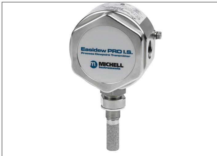
L'Easidew PRO I.S. est un transmetteur du point de rosée en sécurité intrinsèque robuste à 2 fils servant à mesurer la teneur en humidité des liquides et des gaz. Il est homologué pour utilisation dans les zones dangereuses de Classe 1 Div 1 Groupes A,B,C et D, EXII 1G EX ia IIC T4 et I.S. I 1 ABCD T4 (Ta = +60°C).
