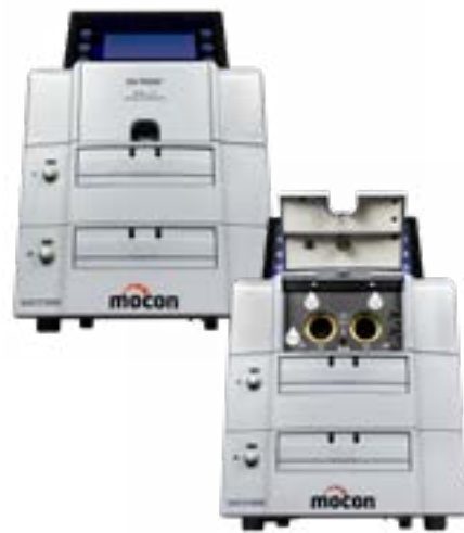
Modulares Kassettensystem - Wechselkassetten mit unterschiedlichen Messflächen, zur Vermeidung des Edge-Effekts oder zum Anschluss von Packungen oder Remote-Zellen
