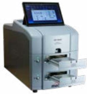
Modulares Kassettensystem - Wechselkassetten mit unterschiedlichen Messflächen, zur Vermeidung des Edge-Effekts oder zum Anschluss von Packungen oder Remote-Zellen
