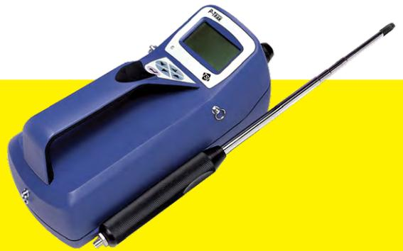
Der TSI Ultrafeine Partikelzähler (UPC) P-TRAK® 8525 eignet sich hervorragend zur Messung ultrafeiner Partikel am Arbeitsplatz sowie zur Behebung von Problemen bei der Luftqualität in Innenräumen (IAQ). Dieses tragbare Instrument erfasst und zählt ultrafeine Partikel (kleiner als ein Mikrometer), die häufig mit Schmutzpartikeln auftreten oder auf deren Vorhandensein hinweisen und Ursache von Beschwerden sind.
