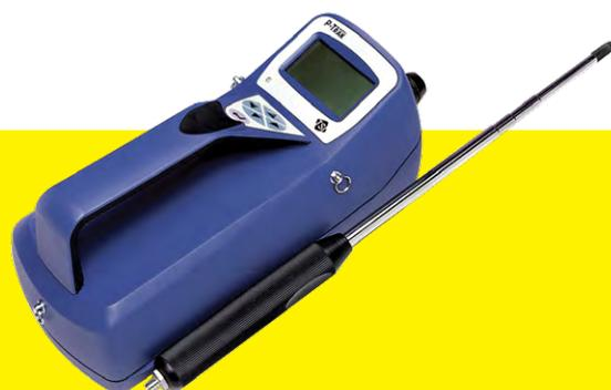
Le compteur de particules ultrafine (UPC) P-Trak® 8525 de TSI est un instrument dédié à la mesure des niveaux de particules ultrafine sur le lieu de travail et à l'identification des problèmes de qualité de l'air intérieur (QAI). Cet instrument portable détecte et compte les particules ultrafine ou les nanoparticules (inférieures à un micromètre) qui accompagnent ou signalent généralement la présence d'une substance polluante, source de plaintes.
