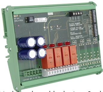
Module adressable de 4 ou 8 relais programmables pouvant être déporté au plus près des asservissements afin de réduire les coûts de câblages. Chaque module dispose aussi de deux entrées logiques.
