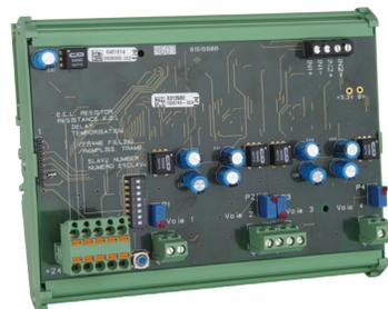
Module adressable de 4 sorties analogiques (recopie signal capteur, min, max, moyenne d'un groupe de détecteurs) pour raccordement sur un enregistreur, un automate, une GTB, etc. Chaque module dispose aussi de 2 entrées logiques
