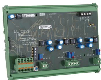
Module adressable de 4 sorties analogiques (recopie signal capteur, min, max, moyenne d'un groupe de détecteurs) pour raccordement sur un enregistreur, un automate, une GTB, etc.
